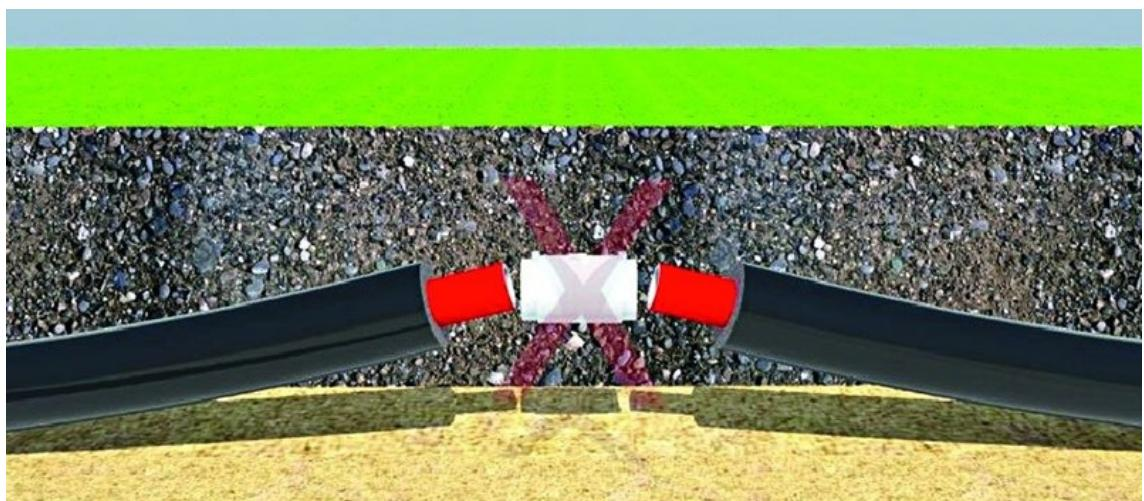
Неправильно. Фитинг для электрофузионной сварки нагружен.
